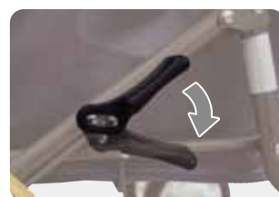
駐車ブレーキ
