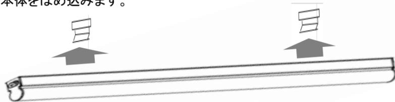
③本体へ付属の接続コードを差し込み、そのコードと2次側の電源線と接続すれば完成です。
