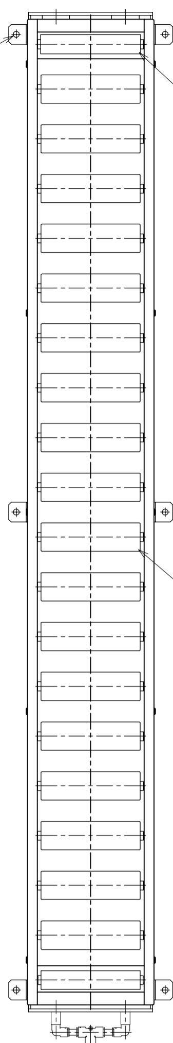
$\phi 38 \times 1.2 t + 12 d \times 200 L$ (両端)
