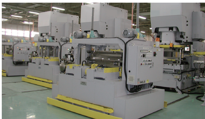
板金プレス用金型交換装置
