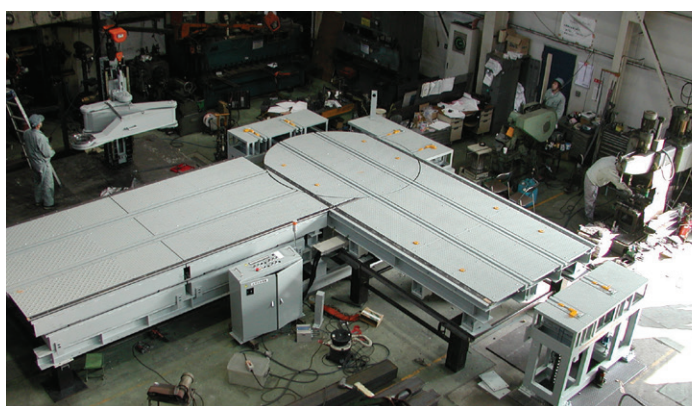
熱間鑄造用金型交換装置
