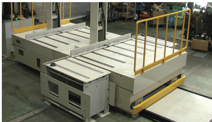
射出成形機用金型交換装置
