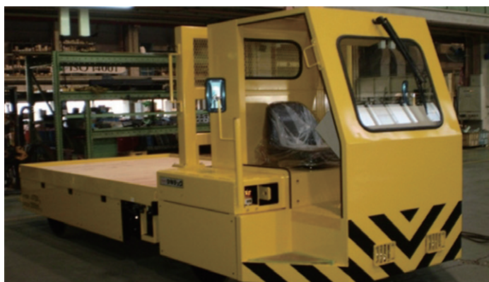
自走式金型搬送バッテリー台車
