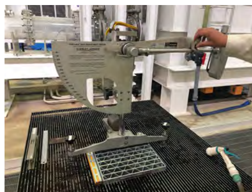
振り子式スキッドレジスタンステストによる試験の様子
