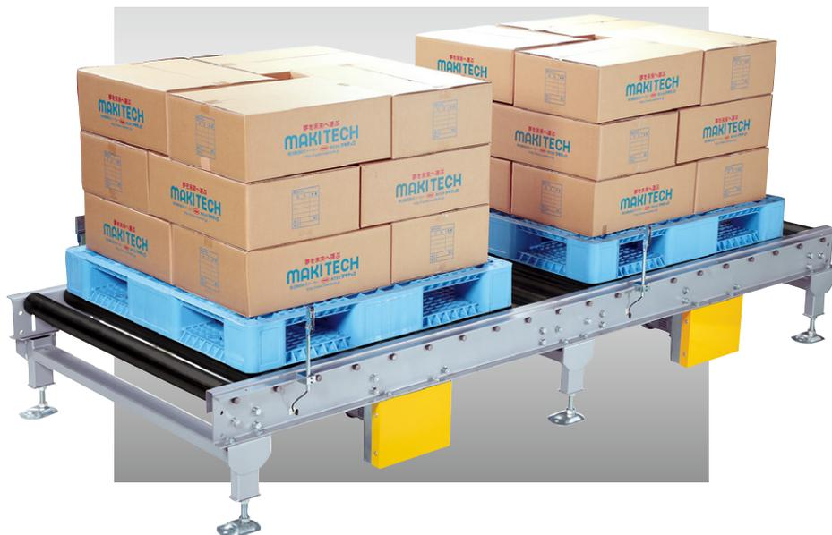
・動作：各ゾーンのセンサーにて搬送物を感知し各ゾーンのモーターをシーケンサーにて制御し、搬送物を前詰め方式にて1個1個間隔をあげストックするアキュムコンベヤです。
