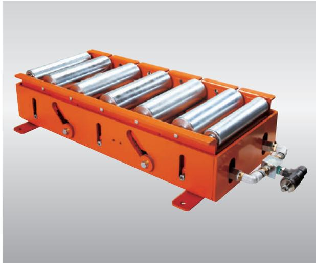
平行リンク機構を内蔵したモーターローラ駆動タイプです。低床でコンパクトな為、スペースのない場所での方向転換に最適です。ホースを2本使用している為高い積載荷重と安定した動作が実現できます。上昇下降検知には近接スイッチが取付可能です。
