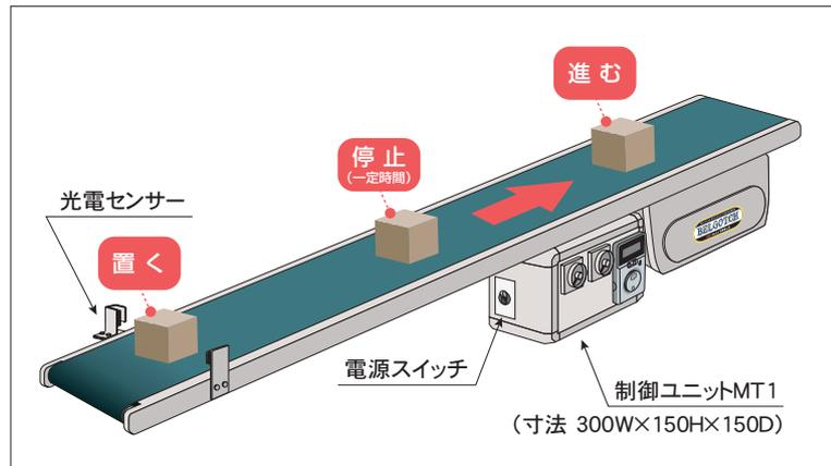
センサー遮光 → タイマ設定時間後(タイマ①)コンベヤ起動
